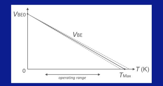
$V_{BE0}$ : Voltage  $V_{BE}$  of a (silicon) diode @ 0K
